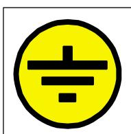
Выполните заземление фильтрующего оборудования согласно нормам вашей страны. Гибким медным проводом сечением 10 мм<sup>2</sup> подключите фильтрующее оборудование к заземлению.
