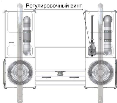
После регулировки верните крышку зафиксируйте ее винтами.
