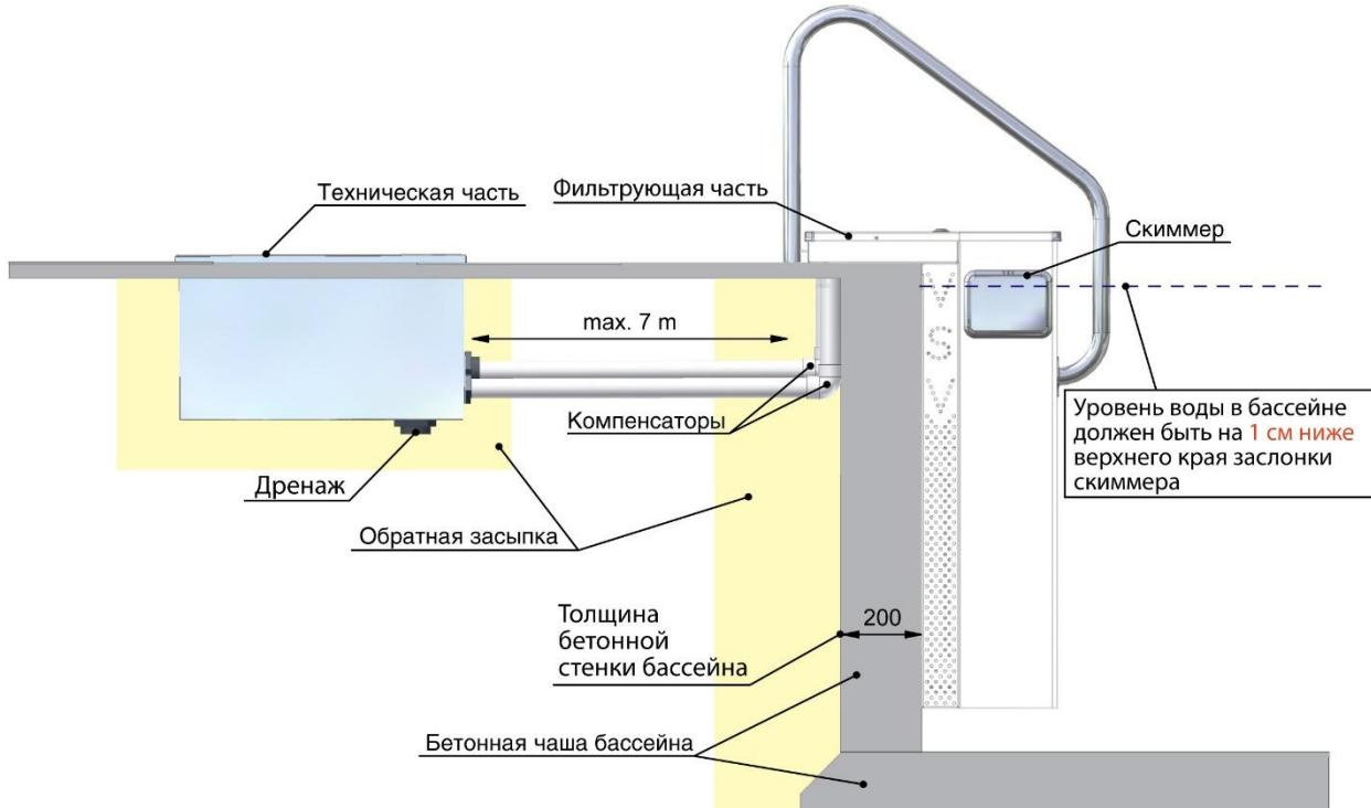
Медленно опустите лестницу в бассейн. Осторожно (чтобы не повредить гидроизоляционное покрытие – лайнер) навесьте лестницу на стенку бассейна, как указано выше. При необходимости выровняйте с использованием ватерпаса и закрепите лестницу крепежными болтами (входят в комплект оборудования) в предусмотренных местах (см. рисунок «Вид сверху»).
