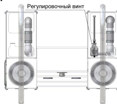
После регулировки верните крышку зафиксируйте ее винтами.
