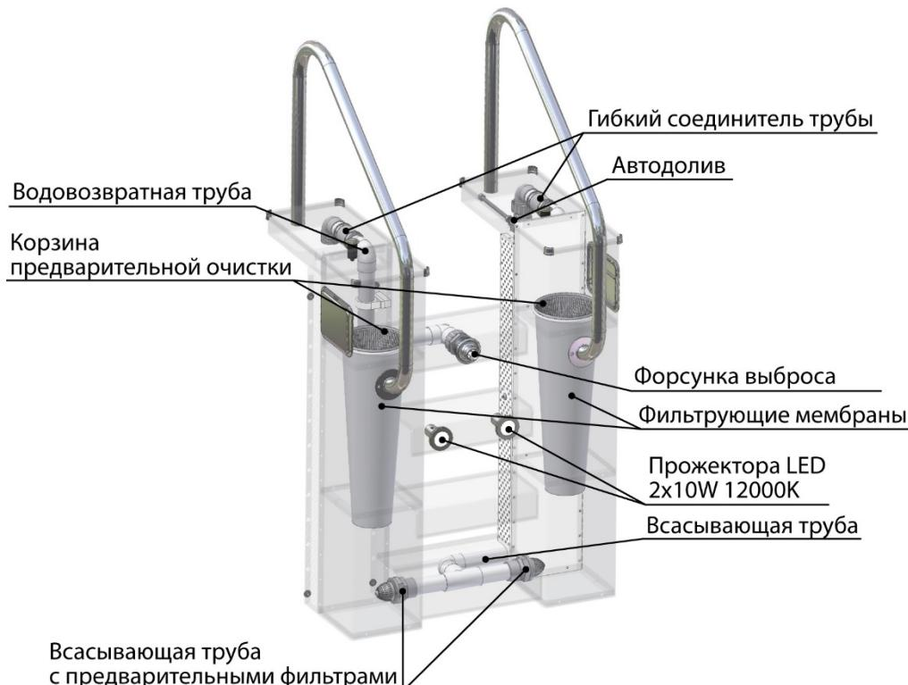
**Фильтрующая часть** включает две корзины предварительной очистки + две крышки для подключения водного пылесоса, две стандартных фильтрующих мембранны (6-15 микрон), скиммера (по бокам фильтрующей части), водовозвратную трубу + форсунку выброса воды, прожектора 2x10W 12000K, пневматические кнопки включения прожекторов и функции встречного течения, долив воды, всасывающую трубу с предварительными фильтрами.
