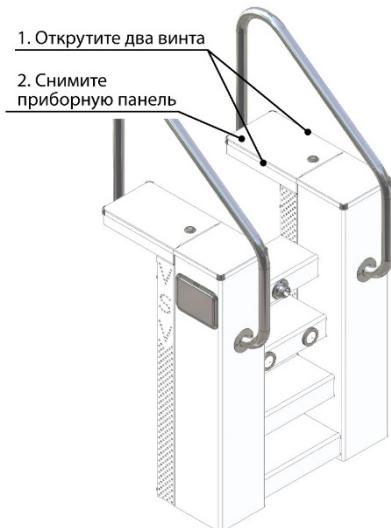
Для этого необходимо открутить два винта с боков фильтрации (см. рисунки), снять крышку и отрегулировать винт долива так, чтобы подача воды прекращалась, не доходя **1 см** до верхнего края заслонки (лопатки) скиммера (см. раздел «Долив воды» на стр.12).
