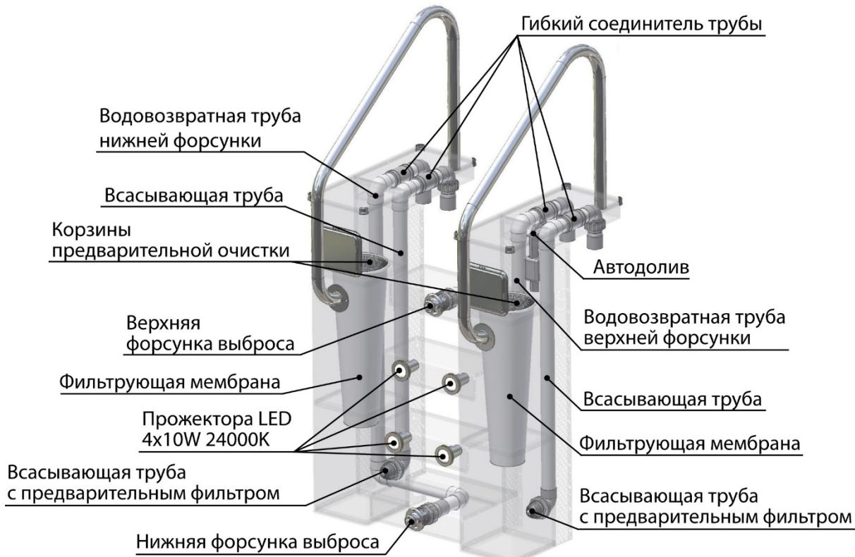
**Фильтрующая часть** включает две корзины предварительной очистки + крышку для подключения водного пылесоса, две стандартных фильтрующих мембранны (6-15 микрон), скиммера (на фронтальной стороне фильтрующей части), две водовозвратные трубы с форсунками выброса, прожектора 4x10W 24000K, долив воды, всасывающие трубы с предварительным фильтром, болт заземления.
