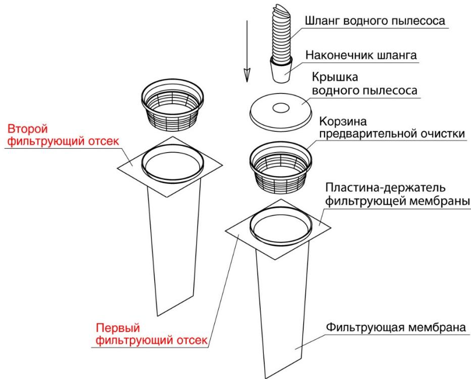
**ВНИМАНИЕ!** Шланг водного пылесоса должен быть герметично соединен с наконечником шланга во избежание подсасывания воздуха и попадания в помпу.
