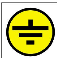
Выполните заземление фильтрующего оборудования согласно нормам вашей страны. Гибким медным проводом сечением 10 mm<sup>2</sup> подключите фильтрующее оборудование к заземлению.
