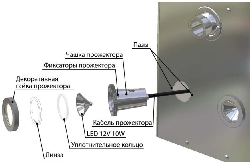
Отключите электропитание фильтрующей установки. Проверните прожектор по часовой стрелке, пока фиксаторы прожектора не попадут в пазы на передней части фильтрации. Достаньте прожектор из воды, осторожно вытягивая запас кабеля.
